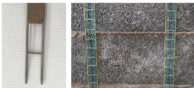
Bild 2.1 Förstärkningsmaterial: avslitet bistål (vänster); vajerarmering (höger).
