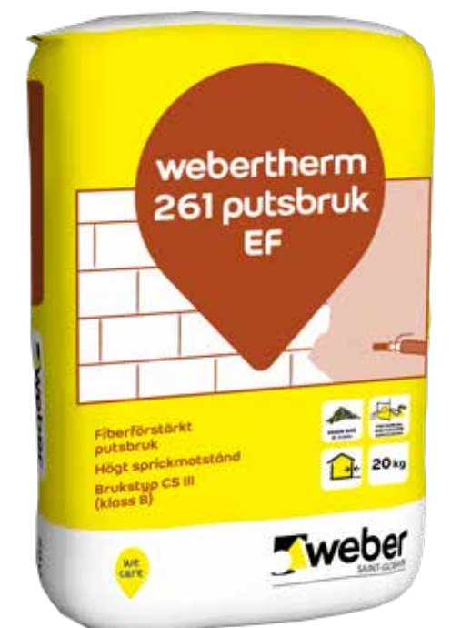
webertherm 261 EF bruk – KC-baserat fiberarmerat putsbruk för putsning i totalt 8–10 mm tjockt skikt. Finns i 25 kg säck eller 1000 kg storsäck.
