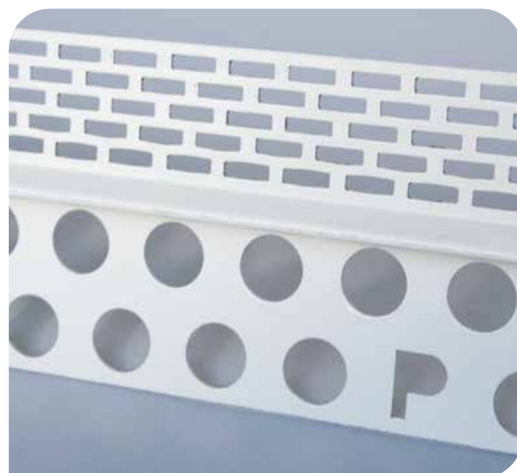
webertherm 402 Takfotslist – Vitlackerad perforerad aluminiumlist som används som avslut mot takfot. Perforeringen är 25 mm eller 50 mm hög.
