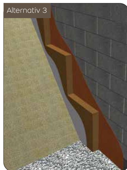
Figur 5.5: Källarvägg med Isodrän
