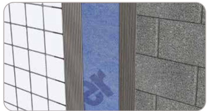
Figur 5.6: Tätskiktssapplikation på Leca Block
