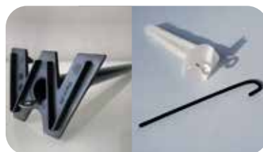
webertherm 312 Fäste TB alt. webertherm 315 fäste – Rostfritt stål med initialvinkel och spärrkramla. Kombinerar med en skruv som anpassas till underlaget. Finns i olika längder 30–150 mm.
