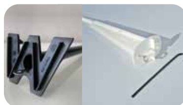
webertherm 312 fäste MTB alt. webertherm 315 fäste – Rostfritt stål med initialvinkel och spärrkramla. Levereras komplett med skruv. Avsett för underlag av betong. Finns i längder avsett för isolertjocklek 150, 180 och 200 mm.
