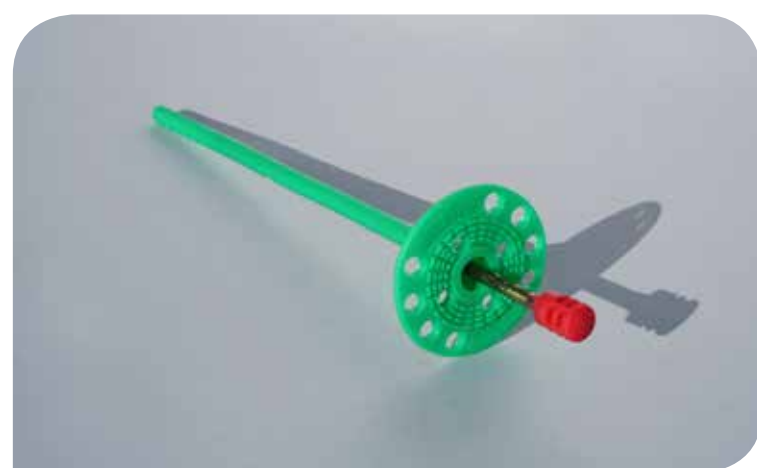
Therm 395 EF-K – Kompletta slagankarfäste avsett för montage av isolering på betong och massiv-tegelunderlag. Längden ska vara isoleringstjocklek + minst 35 mm. Åtgång: ca 5,5 st/m 2
