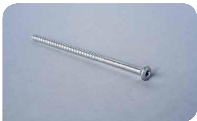
Therm 406 Träskruv – Skruv avsedd för infästning i träunderlag ihop med Therm 396 EF-R. Ska skruvas in minst 45 mm i underlaget. Grepp Torx 25. Åtgång: ca 5,5 st/m 2
