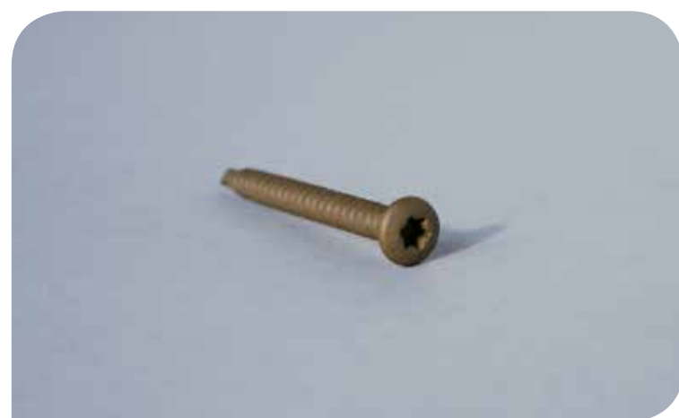
Therm 408 Skruv för plåtregel – Skruv med borrhåla avsedd för montage i plåtregel 0,9–2 mm godstjocklek i kombination med Therm 396 EF-R. Grepp Torx 25. Åtgång: ca 5,5 st/m 2
