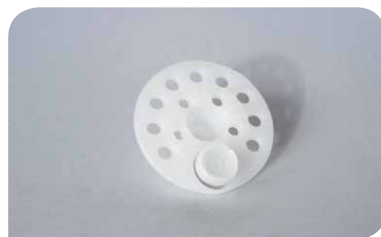
Therm 396 EF-R – Isoleringshållare till träunderlag. Kompletteras med skruv Therm 406 till träunderlag alt. Therm 408 för plåtregel. Skruvas minst 45 mm i underlaget. Åtgång: ca 5,5 st/m 2
