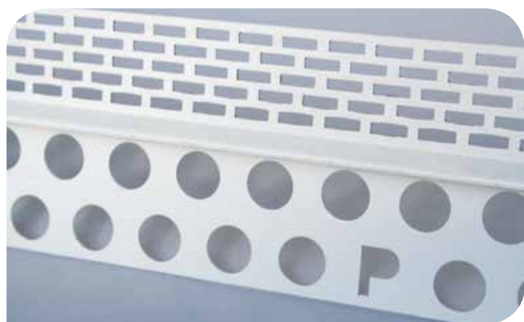
Therm 402 Takfotslist – Vitlackerad perforerad aluminiumlist som används som avslut mot takfot. Perforeringen är 50 mm hög.
