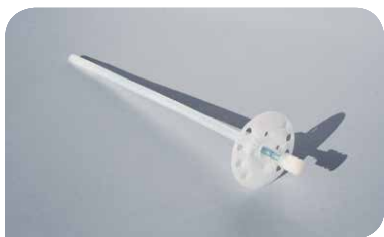
Therm 394 EF-L – Kompletta slagankarfäste avsett för montage av isolering på underlag av porösa material såsom lättbetong, lättklinker och håltegel. Längden på fästet ska vara isoleringstjocklek + minst 70 mm. Åtgång: ca 5,5 st/m 2
