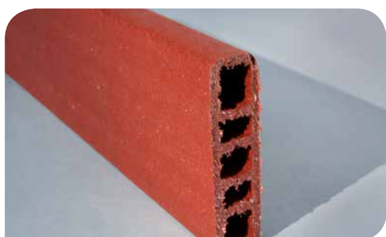
Therm 410 Infästningsplank – Plankprofil av återvunnen plast som fälls in i isoleringen och putsas över. Endast för lättare montage såsom ringklockor, och mindre armeringar.
