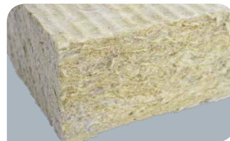
Therm 398 mw-skiva – Mineralullsskiva speciellt framtagen till puts-systemet i 2 densiteter 180/90 kg/m 3 och den hårda markerade sidan ska vara utåt. Storlek 1200x600 mm. Åtgång: ca 1,05 m 2 /m 2
