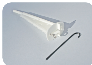
Therm 312 Fäste MTB – Rostfritt stål med initialvinkel och spärrkramla. Levereras komplett med skruv. Avsett för underlag av betong. Finns i längder avsett för isolertjocklek 150, 180 och 200 mm.
