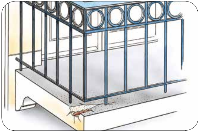
1. Exempel på skadad betongkonstruktion.
