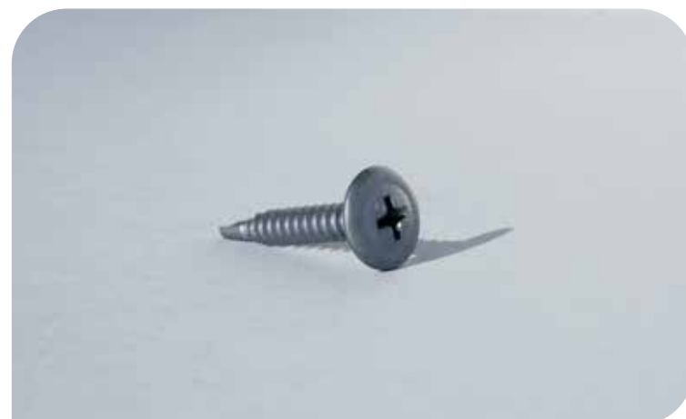
Weber Skivskruv – QU/QUB 25 används för fastsättning av WP-skivan i ventilerande avståndprofil, samt för montering av avståndprofilerna i det ventilerade fasadsystemet, i upp till 2,1 mm stål- eller träregel. Skruven är C4-klassad. Bits PH2.
