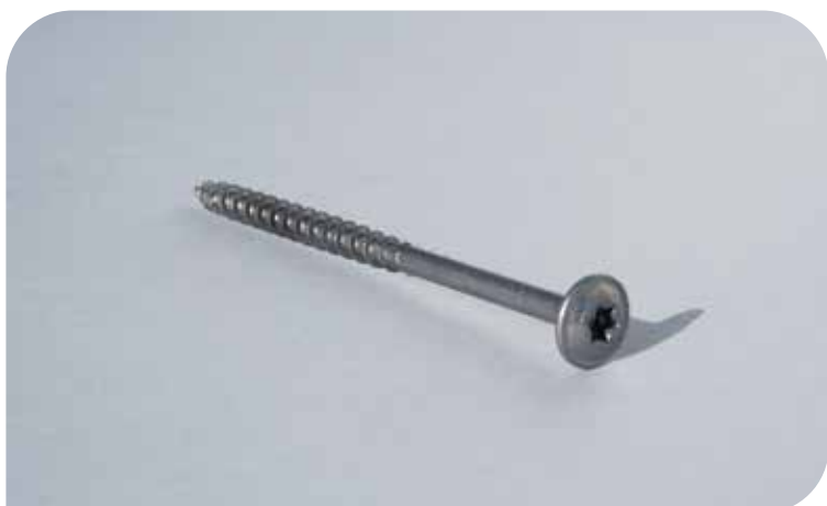
SPAX® 100 – Spax skruv används för montering av avståndprofilerna (VAP) i det isolerade ventilerade systemet. Skruven är C4-klassad och har hög hållfasthet. Bits Torx 30.
