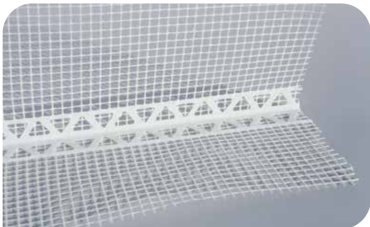
webertherm 391 Hörnlist – Hörnförstärkning av glasfiber som monteras i smygår och hörn. Ska monteras med 100 mm överlapp. Finns i olika bredder beroende på smygdjupet. Längd 2,5 m.
