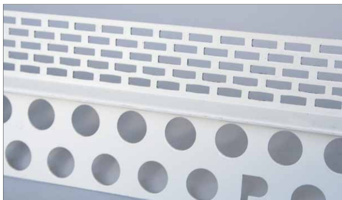
Therm 402 Takfotslist – Vitlackerad perforerad aluminiumlist som används som avslut mot takfot. Perforeringen är 25 mm eller 50 mm hög.
