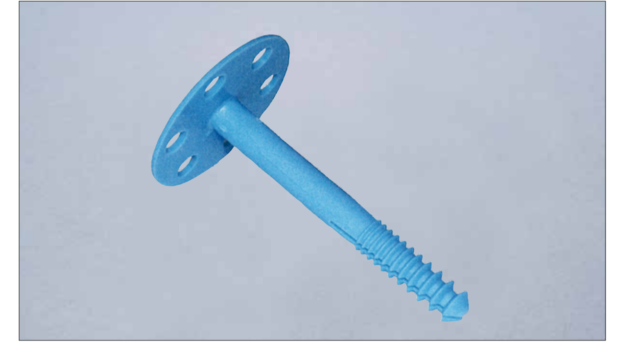
Weber 416 Säkerhetsinfästning – Plugg för montering genom glasfibernätet då man är osäker på putsbrukets vidhäftningsförmåga på det befintliga underlaget. Samt då befintligt putsunderlag med bom behöver förankras innan renovering.
