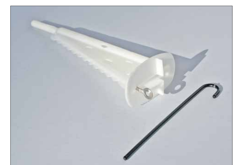
Therm 312 Fäste MTB – Fäste för montage av Therm 321 Skiva i Serporoc fasadssystem på underlag av betong. Finns i längderna 150, 180 och 200 mm, komplett med skruv. Åtgång: ca 5,5st/m 2
