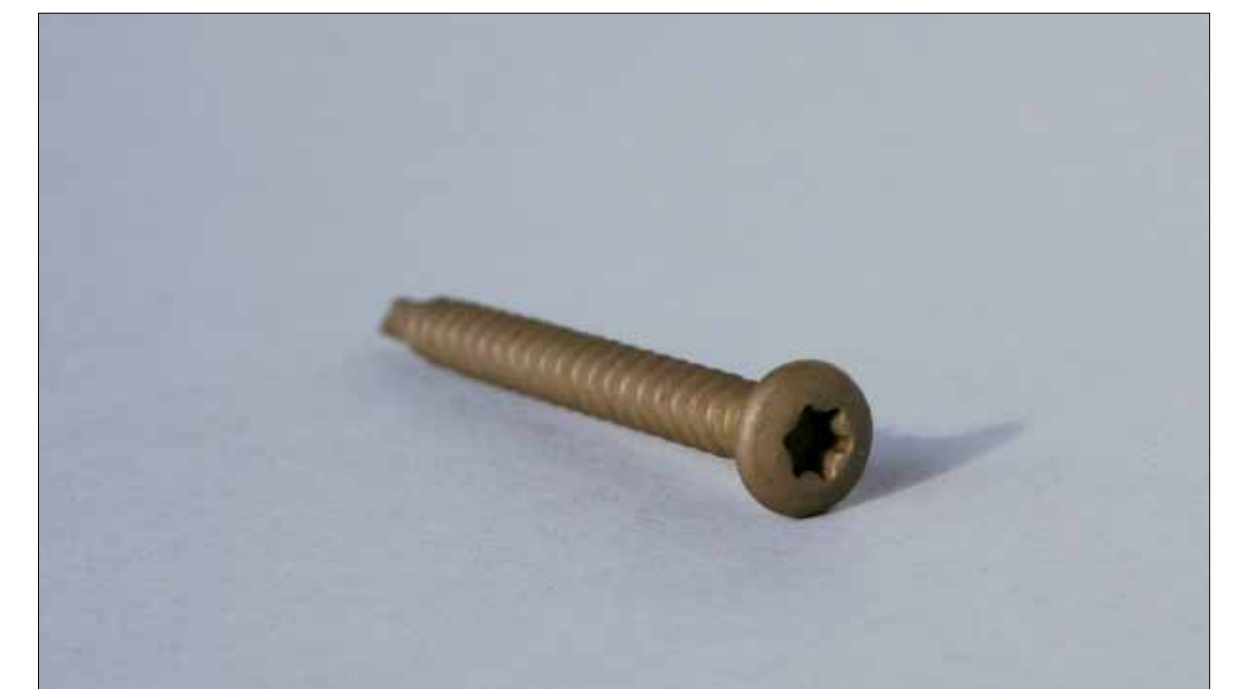
Therm 408 Skruv för plåttregel – Skruv med borspets avsedd för montage i plåttregel 0,9–2 mm godstjocklek. Grepp Torx 25. Åtgång: ca 5,5st/m 2
