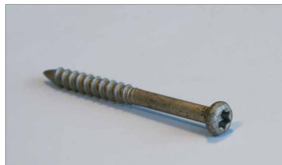
Therm 317 Tegelskruv – Skruv avsedd för montage direkt i massivtegel i kombination med Therm 312 TB. Borrdiameter 5 mm. Skruvdimension 6,3x70 alt. 100 mm. Grepp Torx 25. Åtgång: ca 5,5st/m 2
