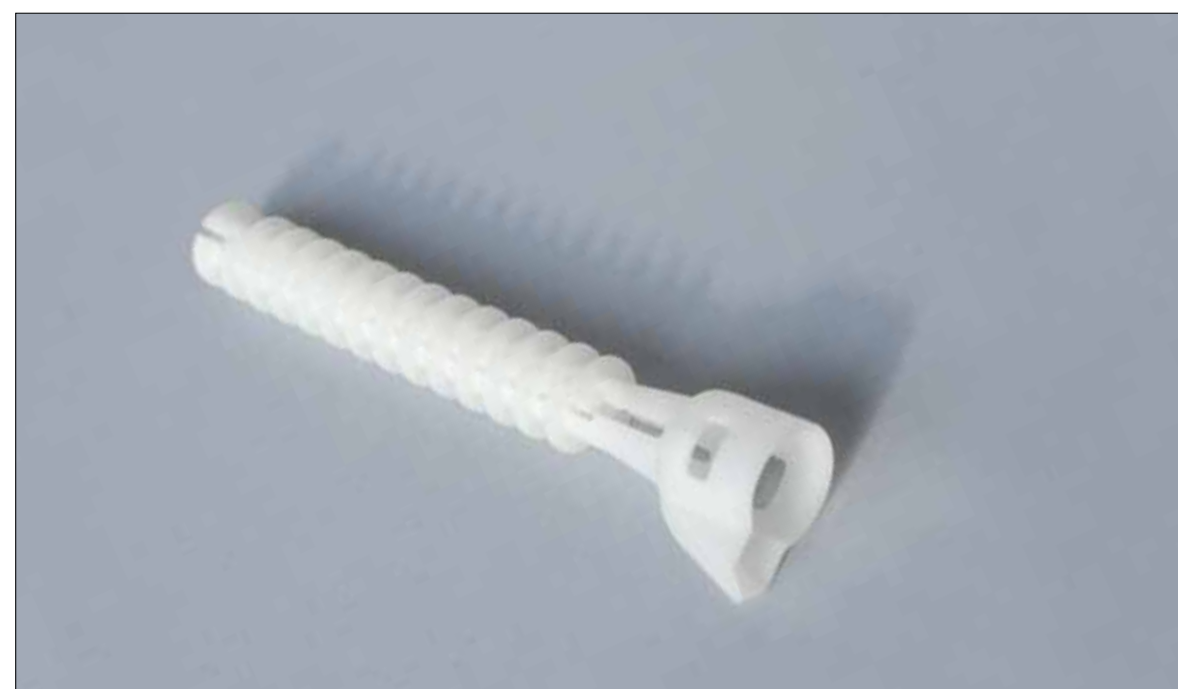
Therm 312 Plugg TB – Används i kombination med Therm 312 Fäste TB, vid lättbetongunderlag, monterar med Therm 409 Skruv. Åtgång: ca 5,5st/m 2
