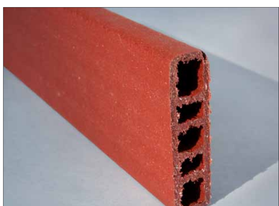
Therm 410 Infästningsplank – Plankprofil av återvunnen plast som fälls in i isoleringen och putsas över. Endast för lättare montage såsom ringklockor, och mindre armaturer.
