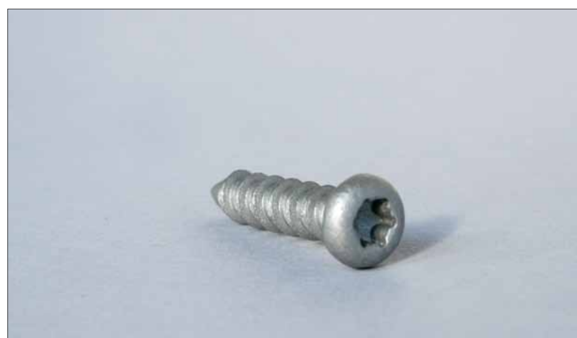
Therm 317 Betongskruv – Skruv avsedd för montage direkt i betong utan plugg i kombination med Therm 312 TB. Borr diameter 5 mm alt 5,5 mm. Skruvdimension 6,1x28 mm. Grepp Torx 25. Åtgång: ca 5,5st/m 2
