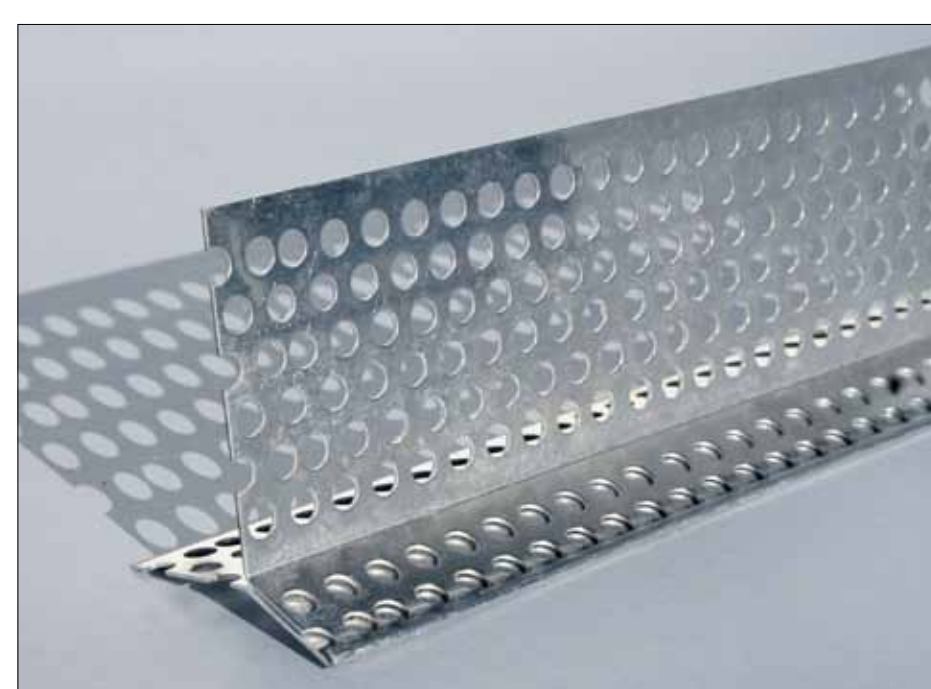
Therm 412 Starlist – Monteras med 325 Clips eller 406 Skruv in i isoleringen. Listerna monterar med ett mellanrum om 5 mm, 323 Stålnät dras över listen. Längd: 2500 mm.
