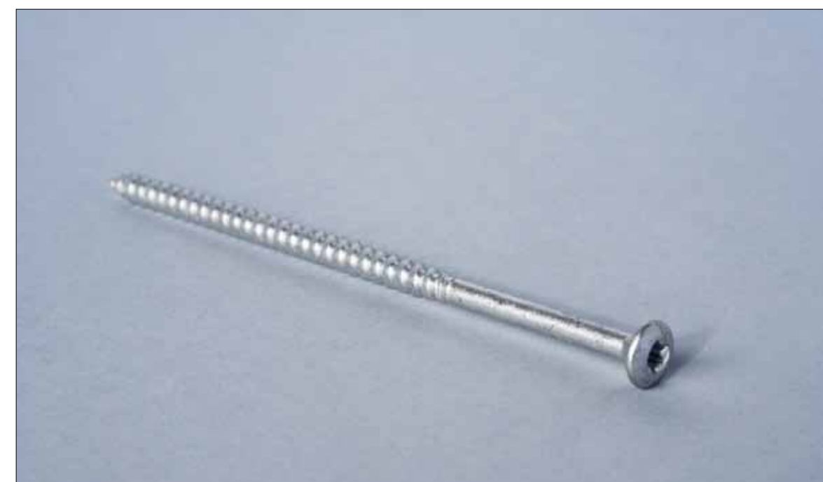
Therm 406 Träskruv – Skruv avsedd för infästning i träunderlag. Ska skruvas in minst 45 mm i underlaget. Grepp Torx 25. Åtgång: ca 5,5st/m 2
