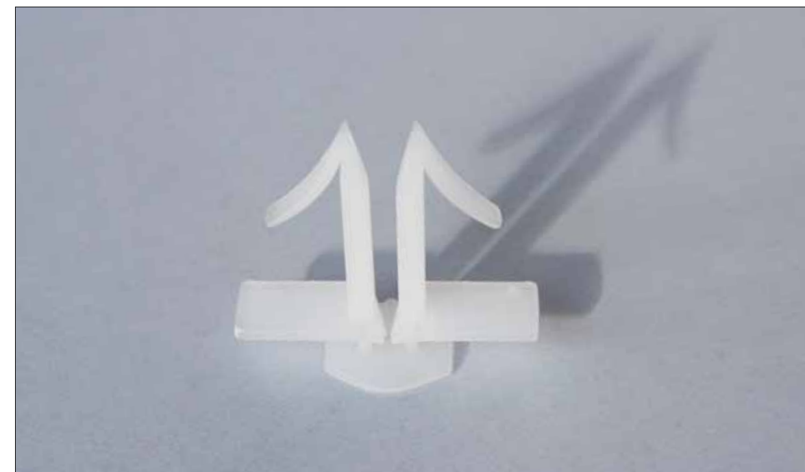
Therm 325 Clips 25 mm – Näthållare avsedd för isolertjocklek 30 mm. Åtgång: ca 5–6st/m 2
