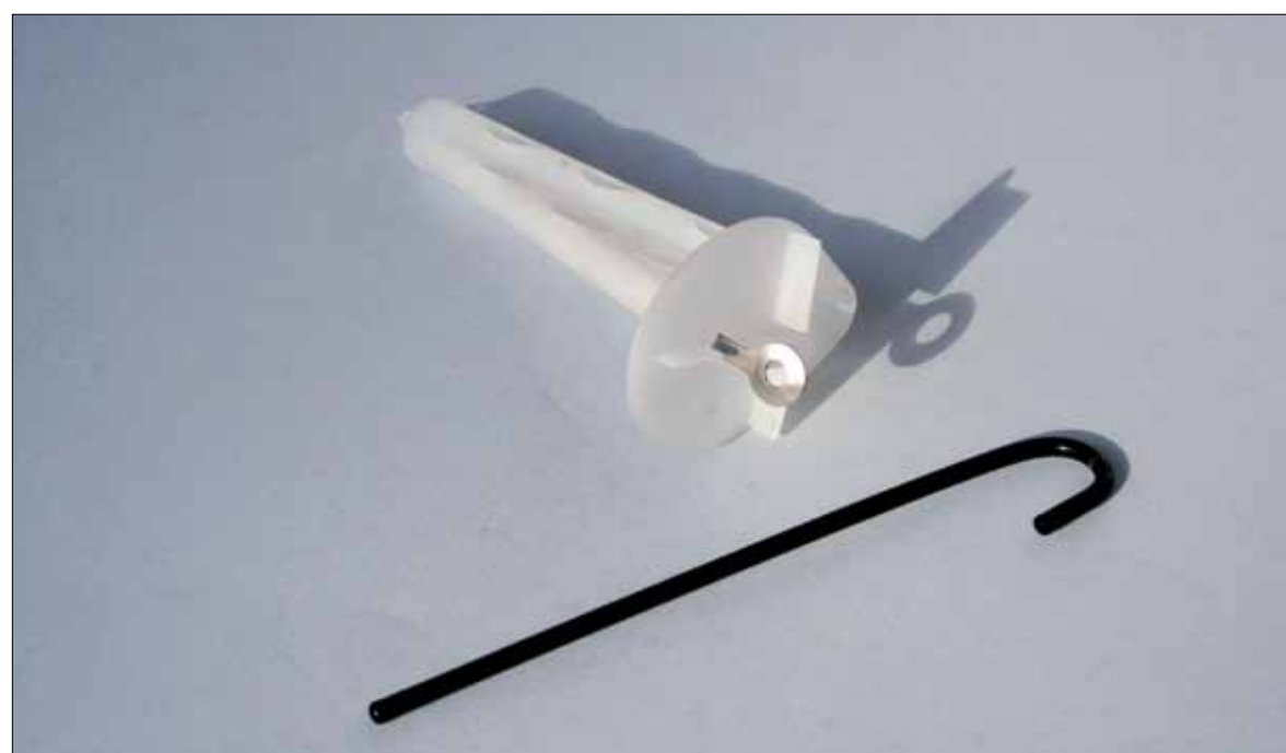
Therm 312 Fäste TB – Rostfritt stål med initialvinkel och spärrkramla. Kombinerar med en skruv som anpassas till underlaget. Finns i olika längder 30–150 mm. Åtgång: ca 5,5st/m 2
