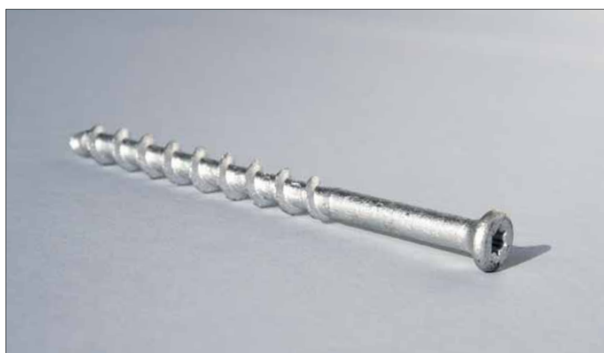
Therm 409 Leca skruv – Skruv avsedd för infästning i Leca och lättklinker utan plugg i kombination med Therm 312. Provdrastring ska alltid utföras. Grepp Torx 25. Åtgång: ca 5,5st/m 2
