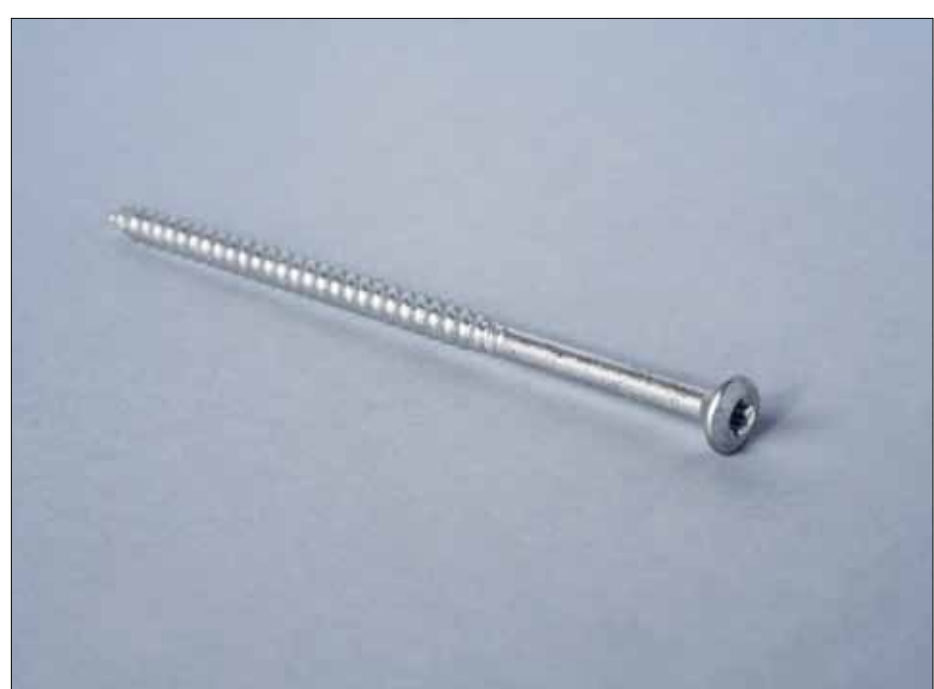
Therm 406 Träskruv – Skruv avsedd för infästning i träunderlag ihop med Therm 396 EF-R. Ska skruvas in minst 45 mm i underlaget. Grepp Torx 25. Åtgång: ca 5,5st/m 2
