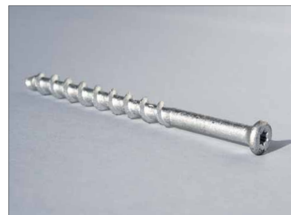
Therm 409 Leca skruv – Skruv avsedd för infästning i Leca och lättklinker utan plugg i kombination med Therm 312. Provdragning ska alltid utföras. Grepp Torx 25. Åtgång: ca 5,5st/m 2
