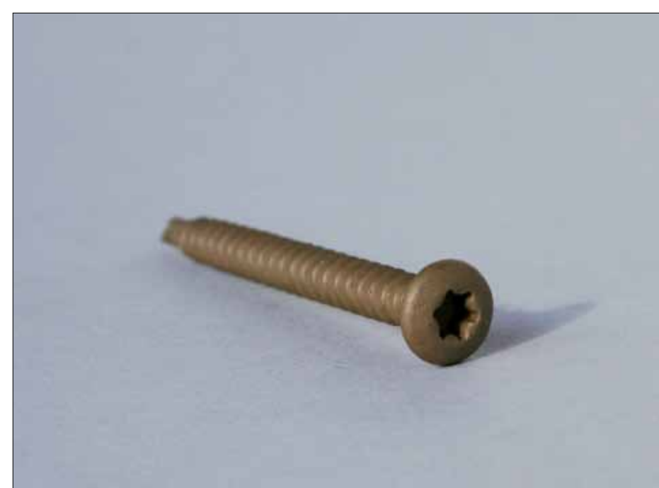
Therm 408 Skruv för plåtregel – Skruv med borrarpspets avsedd för montage i plåtregel 0,9–2 mm godstjocklek i kombination med Therm 396 EF-R. Grepp Torx 25. Åtgång: ca 5,5st/m 2
