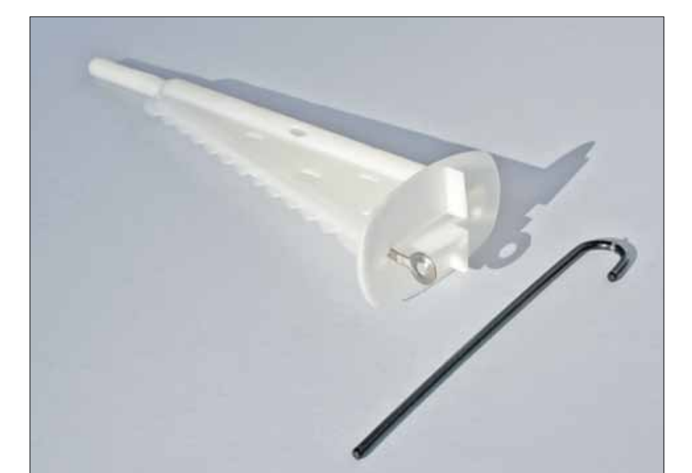
Therm 312 Fäste MTB – Fäste för montage av Therm 321 Skiva i Serporoc fasadsystem på underlag av betong. Finns i längderna 150, 180 och 200 mm, komplett med skruv. Åtgång: ca 5,5st/m 2
