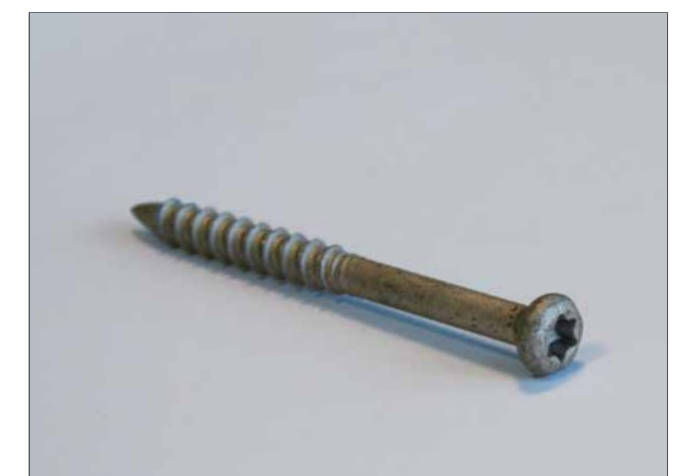
Therm 317 Tegelskruv – Skruv avsedd för montage direkt i massivtegel i kombination med Therm 312 TB. Borrdiameter 5 mm. Skruvdimension 6,3x70 alt. 100 mm. Grepp Torx 25. Åtgång: ca 5,5st/m 2
