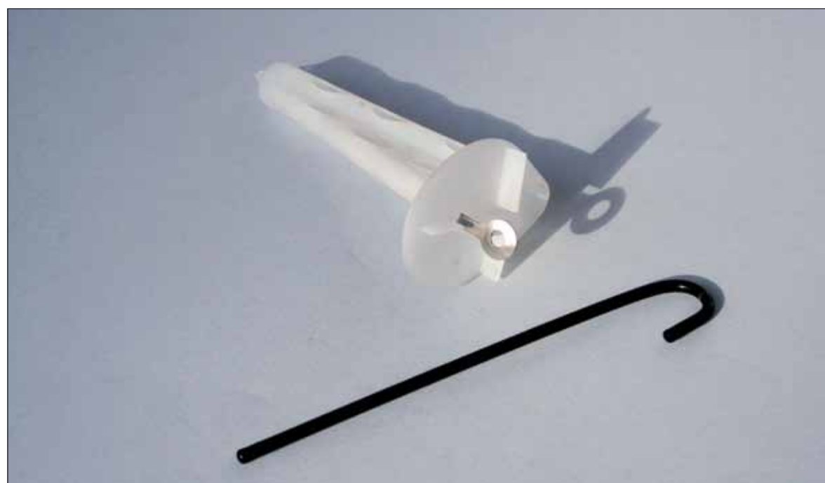
Therm 312 Fäste TB – Rostfritt stål med initialvinkel för infästning i träunderlag ihop med Therm 396 EF-R. Ska skruvas in minst 45 mm i underlaget. Finns i olika längder 30–150 mm. Åtgång: ca 5,5st/m 2
