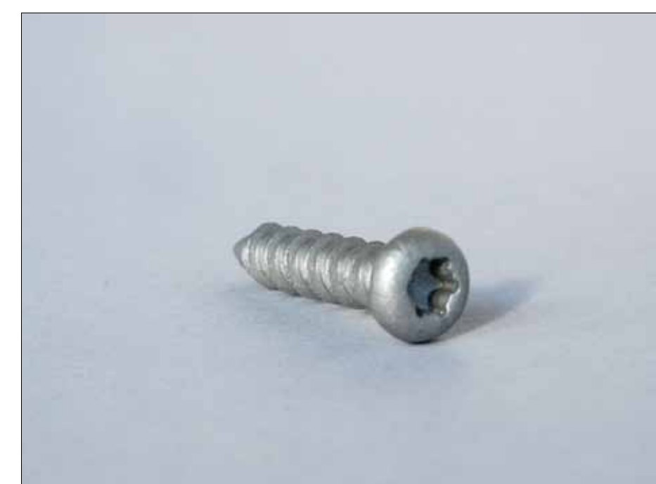
Therm 317 Betongskruv – Skruv avsedd för montage direkt i betong utan plugg i kombination med Therm 312 TB. Borr diameter 5 mm alt 5,5 mm. Skruvdimension 6,1x28 mm. Grepp Torx 25. Åtgång: ca 5,5st/m 2
