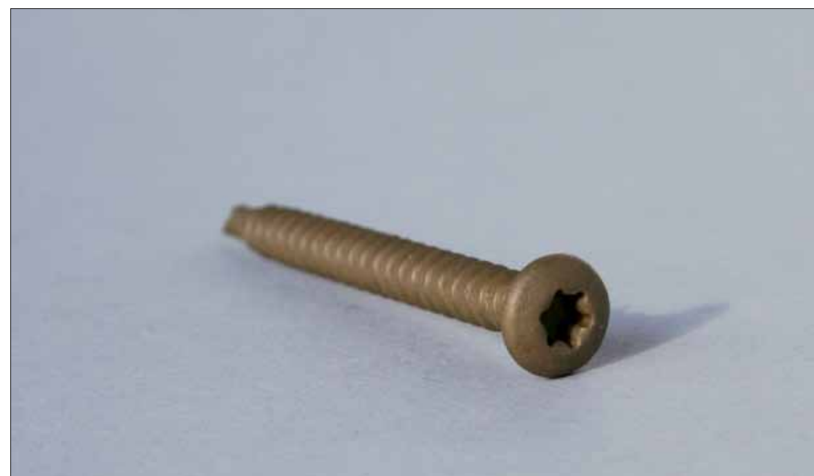
Therm 408 Skruv för plåttegel – Skruv med borrhåls avsedd för montage i plåttegel 0,9-2 mm godstjocklek i kombination med Therm 396 EF-R. Grepp Torx 25. Åtgång: ca 5,5st/m 2
