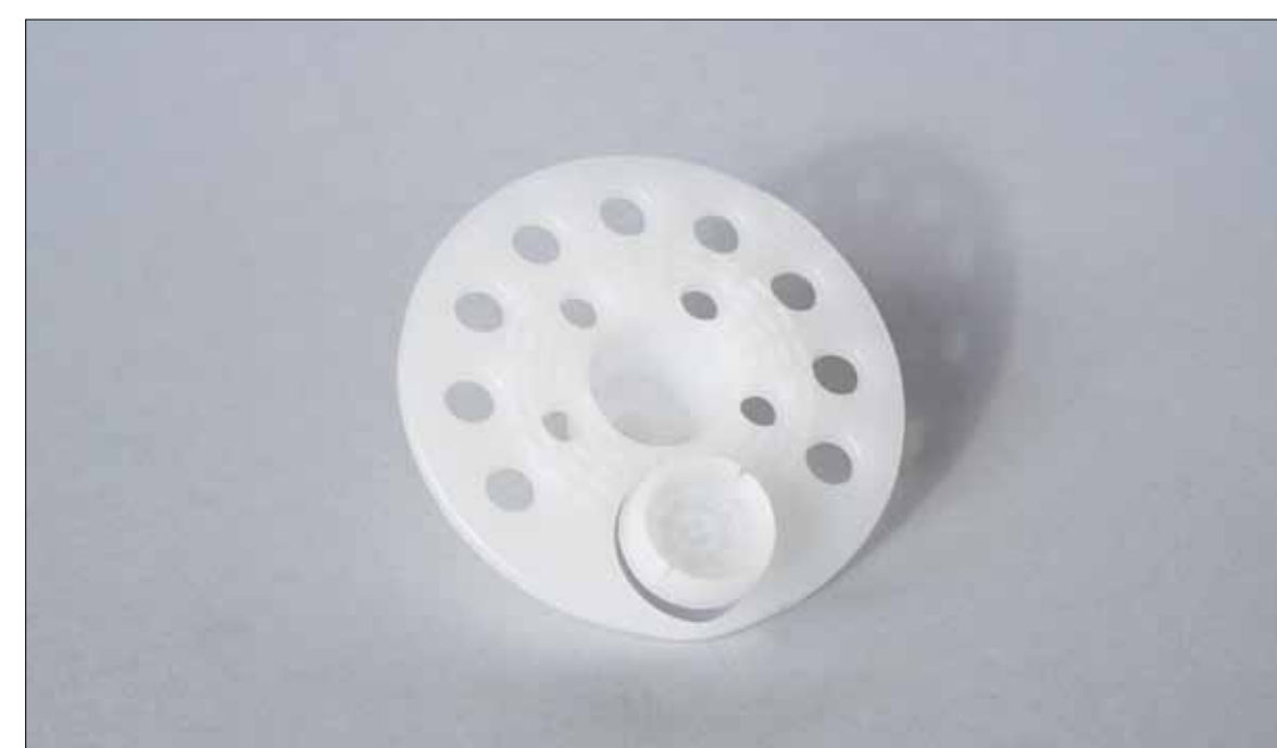
Therm 396 EF-R – Isoleringshållare till träunderlag. Kompletteras med skruv Therm 406 till träunderlag alt. Therm 408 för plåttegel. Skruvas minst 45 mm i underlaget. Åtgång: ca 5,5st/m 2
