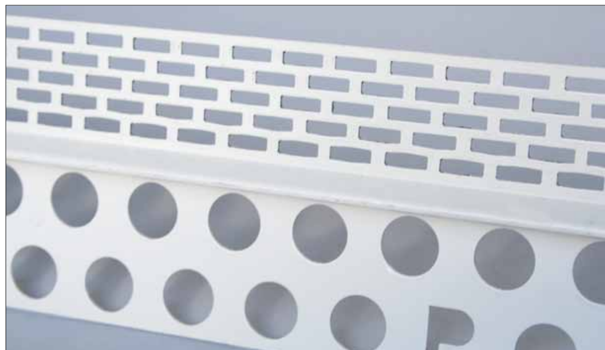
Therm 402 Takfotslist – Vitlackerad perforerad aluminiumlist som används som avslut mot takfot. Perforeringen är 50 mm hög.
