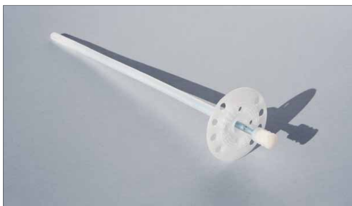
Therm 394 EF-L – Kompletta slagankarfäste avsett för montage av isolering på underlag av porösa material såsom lättbetong, lättklinker och hålltegel. Längden på fästet ska vara isoleringstjocklek + minst 70 mm. Åtgång: ca 5,5st/m 2
