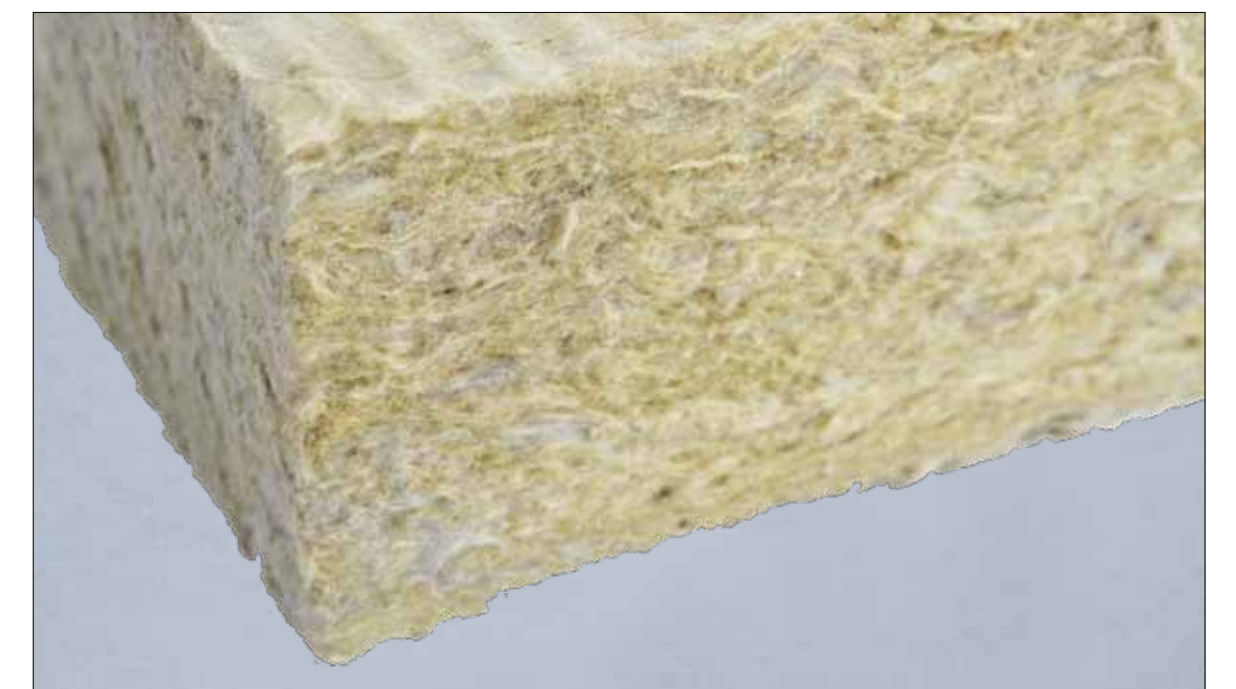
Therm 398 mw-skiva – Mineralullsskiva speciellt framtagen till putsystemet i 2 densiteter 180/90 kg/m 2 och den hårda markerade sidan ska vara utåt. Storlek 1200x600 mm. Åtgång: ca 1,05 m 2 /m 2
