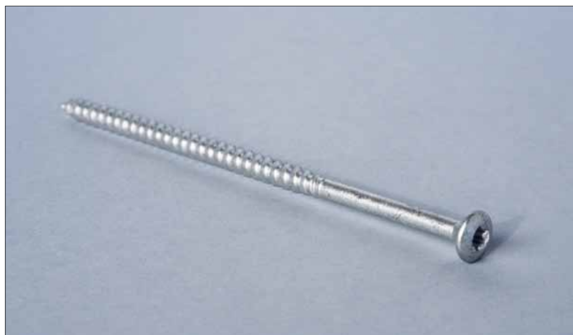
Therm 406 Träskruv – Skruv avsedd för infästning i träunderlag ihop med Therm 396 EF-R. Ska skruvas in minst 45 mm i underlaget. Grepp Torx 25. Åtgång: ca 5,5st/m 2
