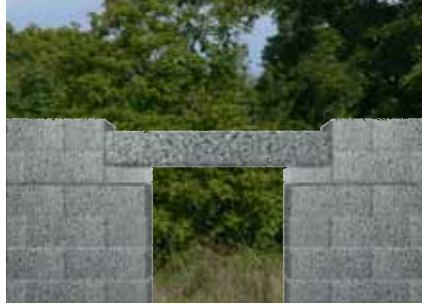
Balkarna finns i längderna 1500, 2400, 3000 och 3900 mm. Passblock förenklar höjdjusteringen.
