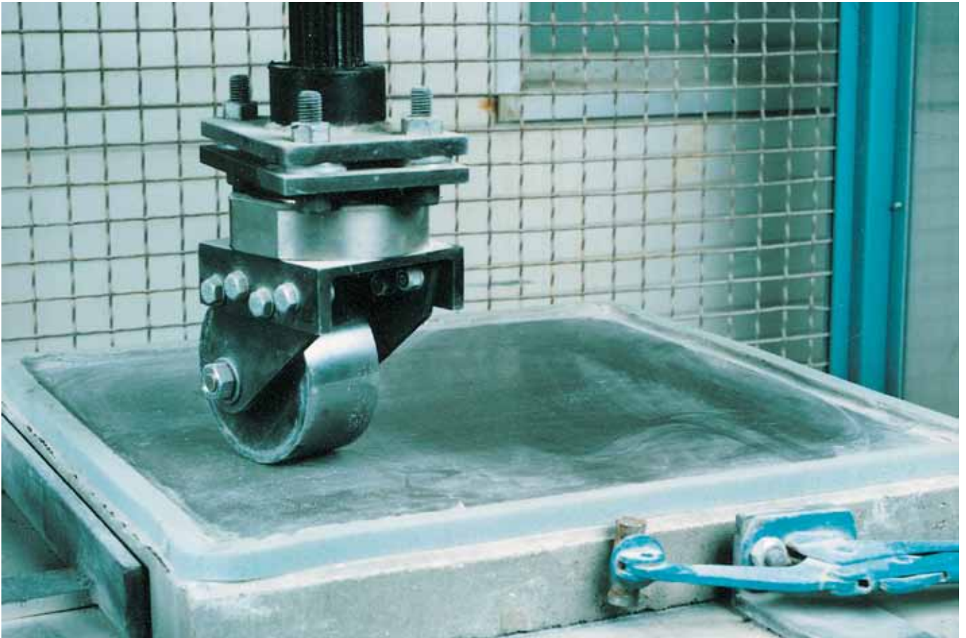
Avnötning med rullande hjul, SP66. Källa: Sveriges Tekniska Forskningsinstitut
