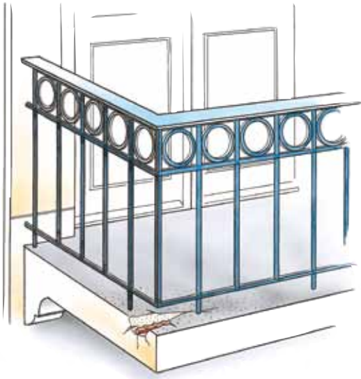
Skada orsakad av karbonatisering.
